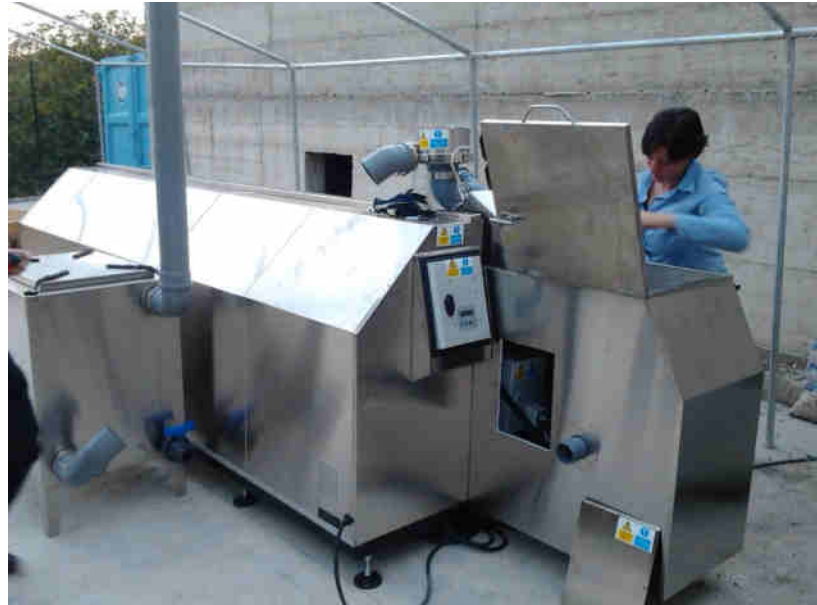
Figura 1. Compostatrice elettromeccanica usata per il compostaggio di prossimità.
